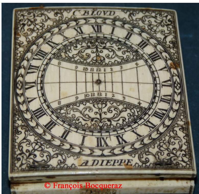
Cadran solaire universel avec signature : « C. BLOVD ADIEPPE ». Un cadran équatorial numéroté de I à XII par deux fois entouré d'une ligne crénelée et décor de fleurs de pavots et arabesques ainsi qu'au centre de la table où figure le cadran polaire chiffré 8 – 12 – 4.
