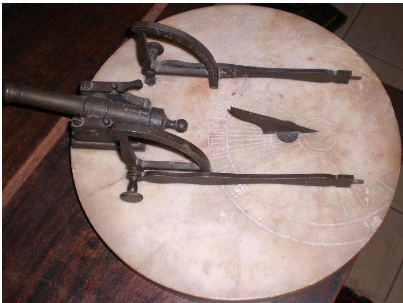
Cadran Méridien – Loupe absente Réalisation des établissements Collin – Table gravée : Collin à Paris, 118 rue Montmartre
